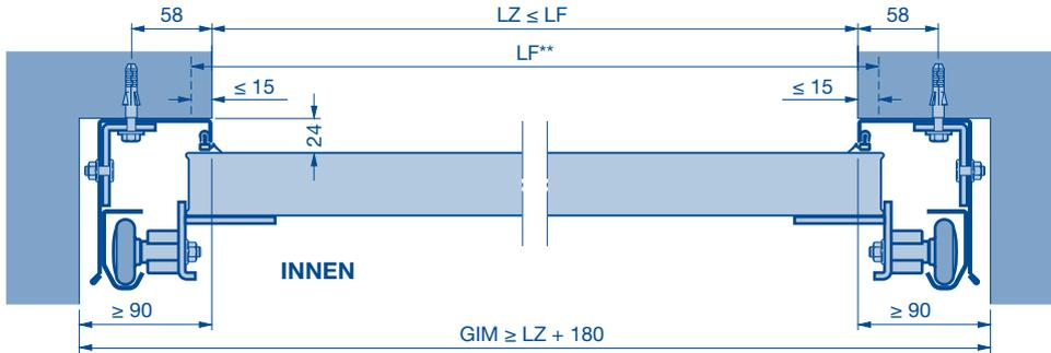
**Anschlagbreite unter 75 mm** oder ohne Anschlag, Befestigung der Zarge mit Spezialanker
