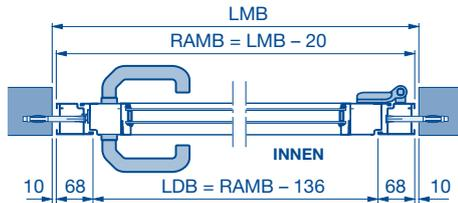
Einbau hinter der Öffnung, nach innen öffnend, DIN rechts oder DIN links
