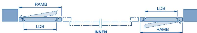
Einbau in der Öffnung, nach außen oder innen öffnend, DIN rechts oder DIN links
