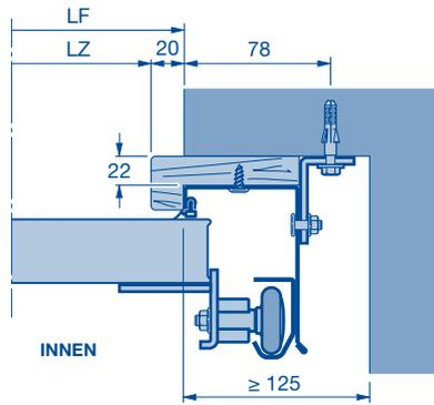
**Anschlagbreite unter 75 mm oder** ohne Anschlag, Befestigung der Zarge mit Spezialanker
