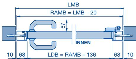
Einbau hinter der Öffnung, nach innen öffnend, DIN rechts oder DIN links
