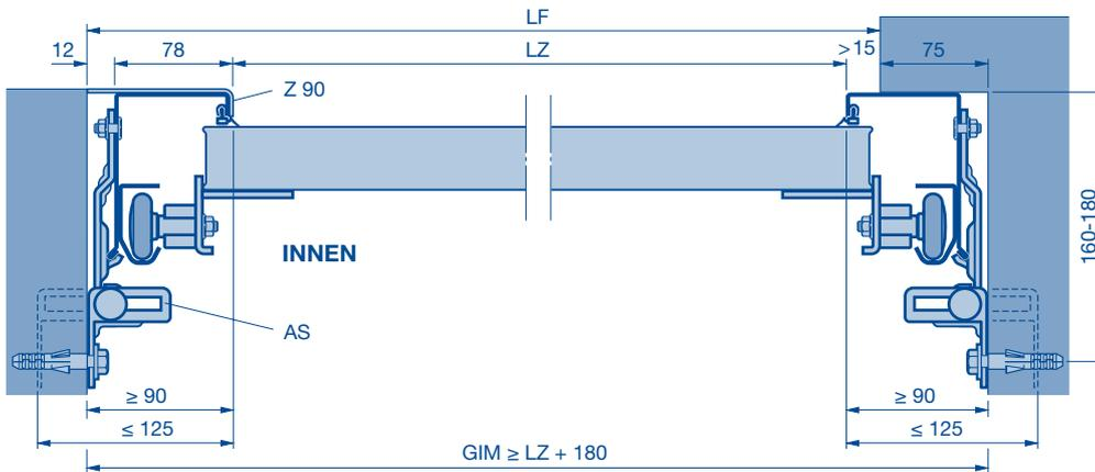
**Anschlagbreite min. 75 mm**, Befestigung auerhalb der Zarge
