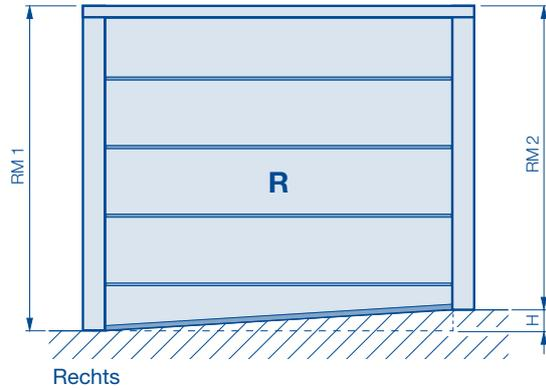
schräge untere Lamelle – Ansicht Anschlagseite (von innen)
