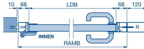
Einbau in der Öffnung, nach innen oder außen öffnend, DIN rechts oder DIN links
