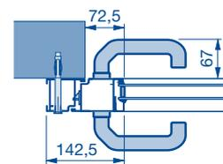
**Lichte Durchgangsbreite bei Flügelöffnung von 90°**
