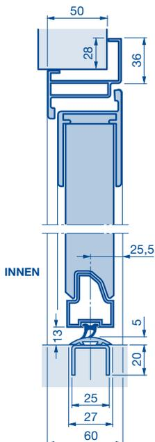
**Lichte Durchgangsbreite bei Flügelöffnung von 90°**
