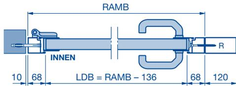
Einbau neben dem Tor, nach innen öffnend, DIN rechts oder DIN links
